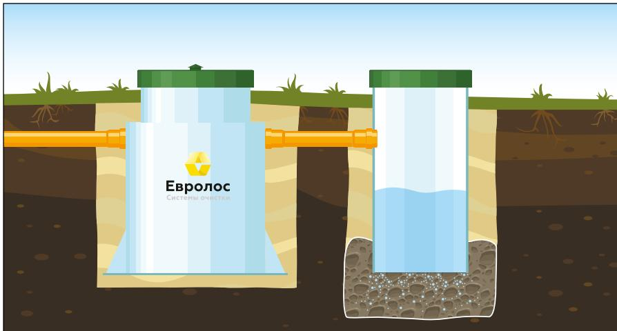
**Вариант 3:** Монтаж с отводом очищенных сточных вод в фильтрующий колодец. Подходит для хорошо поглащающих грунтов (песок, супесь) и низком уровне грунтовых вод.
