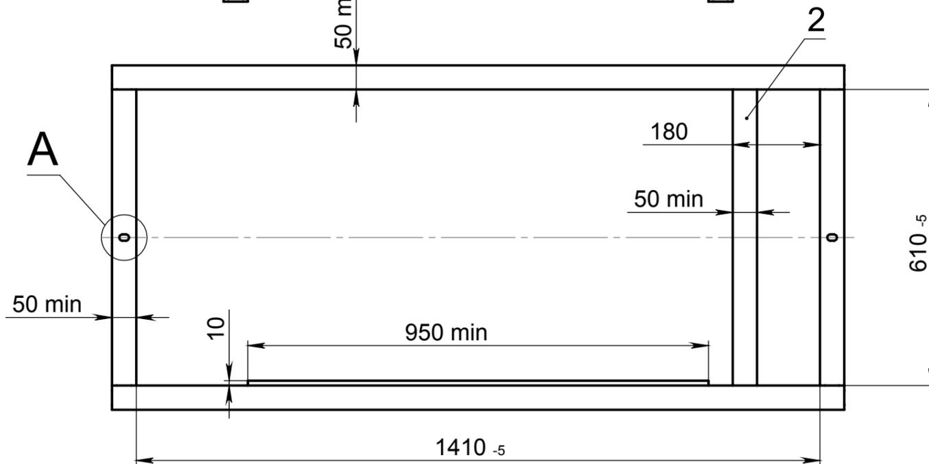
1. Бак ОН800 совместно с промывочным баком П80 из состава бака для навесного опрыскивателя ОНРП800 должны устанавливаться на монтажную раму, при этом:
